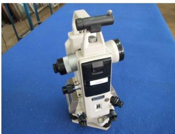
รูปภาพที่ ๓ แสดงกล้องวัดมุมระบบอิเล็กทรอนิกส์ ที่มา: นายชาติชาย ฉัตรทอง. (๒๕๖๓).
